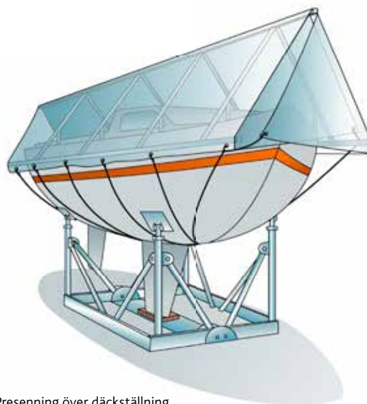
Presenning över däckställning.
